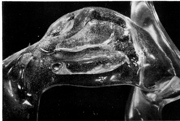
図 4 Ne-U-04 の薬液の沈着状況 (粒子径 15 \mu\text{m} ) (薬液蒸発, 結晶を残す所見) (スパイラルノズル装着)
